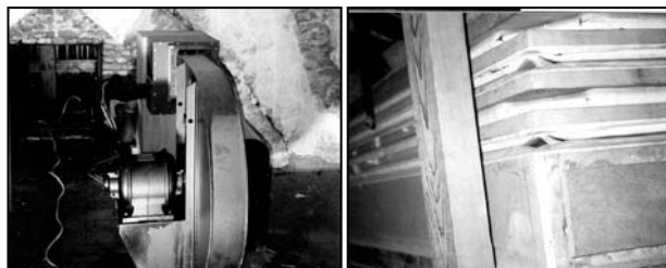
Links de in 1928 geplaatste elektromotor, rechts een deel van de blaasbalgen in de toren van de Sint Jan. Foto Ben Maas
